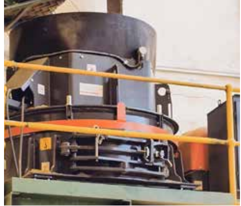
VSI-krossen från Sandvik är central i Enviro Sands hantering av returglas.
