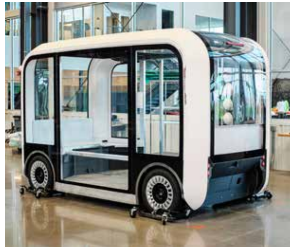
Local Motors minibuss Olli är tillverkad med additiv tillverking och med en slutfinish utförd med verktyg från Sandvik.
