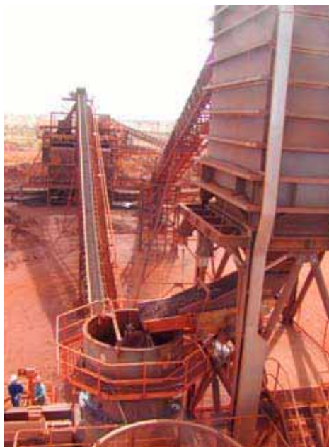
Konkrossen Sandvik CH880 i ett australiensiskt dagbrott.
