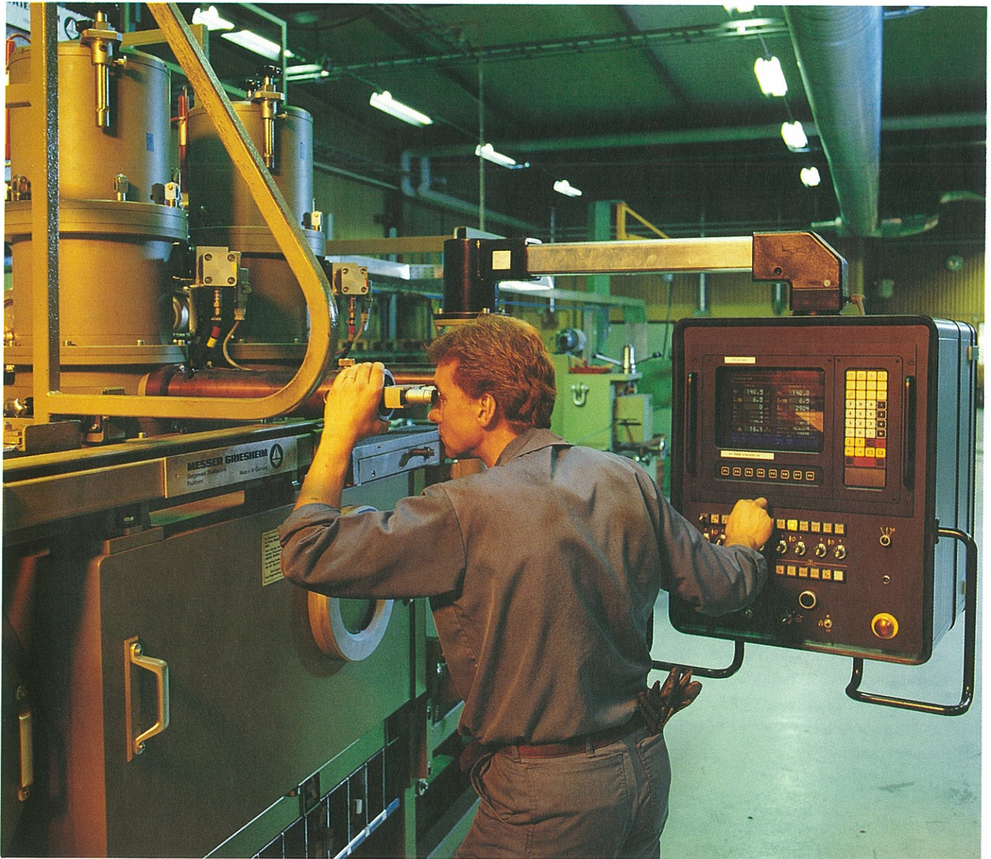
Vid Sandviks produktcenter för metallsågar i Lidköping svetsas bimetallbladen med elektronstråle under vakuum.
